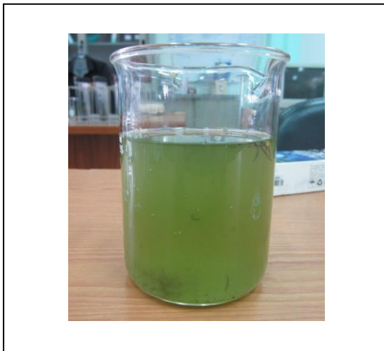
ภาพที่ 7 น้ำทิ้งจากใต้อาคารแพลตด้ารวจ บางมด เขตจอมทอง กรุงเทพฯ มีลักษณะสีเขียวเข้ม มีตะกอนแขวนลอยอยู่ในน้ำมาก กลิ่นเหม็นแรงมาก
